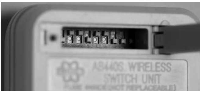
Bild 2.80: Klappe auf: Auf der Rückseite der ELRO-Funksteckdosen ist die DIP-Schalterleiste versteckt, bei der Sie den Hauscode sowie die Schalter-ID per DIP-Schalter konfigurieren.
