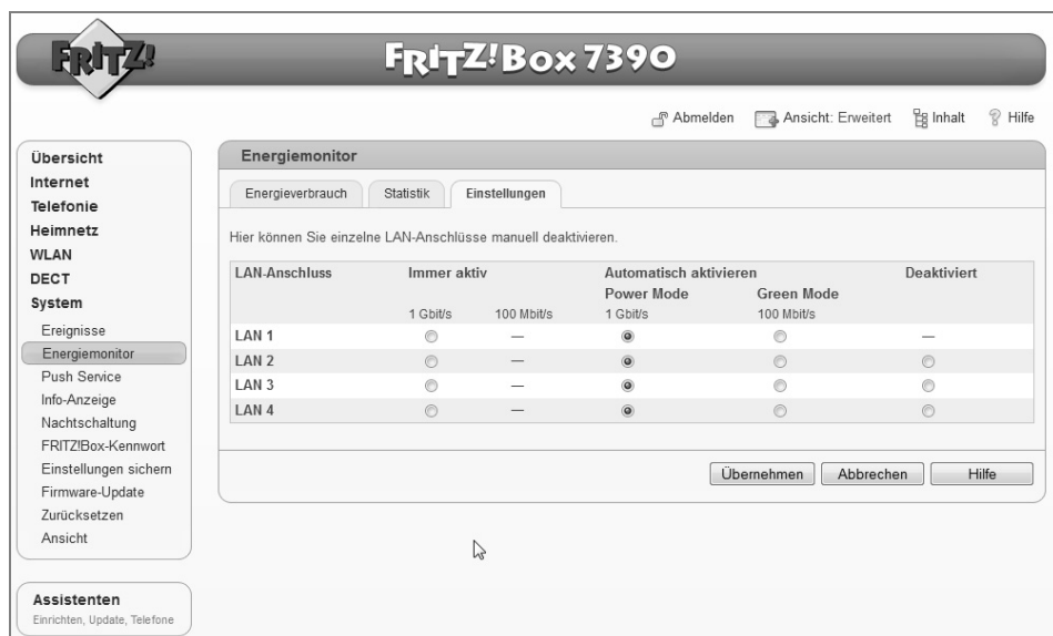
Bild 2.61: FRITZ!Box 7390: Sind sämtliche Anschlüsse fest auf 1 GBit konfiguriert, legen Sie am entsprechenden Anschluss Hand an und setzen ihn auf die Einstellung Green Mode .
