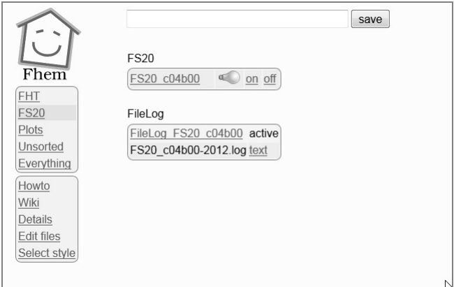
Bild 1.26: Ertappt: Nach dem Einstecken und einem Schaltbefehl wird die Funksteckdose automatisch – hier mit der Bezeichnung FS20_c04b00 – von FHEM erkannt und in der Geräteübersicht gelistet. Über die Aktivitäten des Geräts wird auch automatisch für jedes neue Gerät eine Log-Datei angelegt, die gerade anfangs in Sachen Fehlersuche sehr hilfreich ist.
